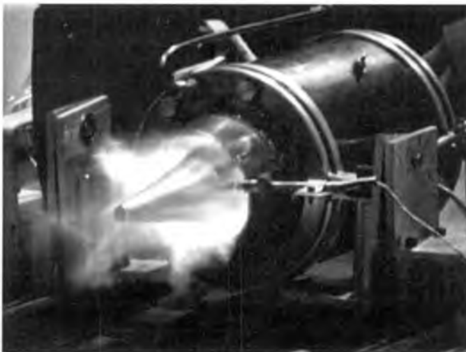
Figura 22. Llama fuera del motor.
