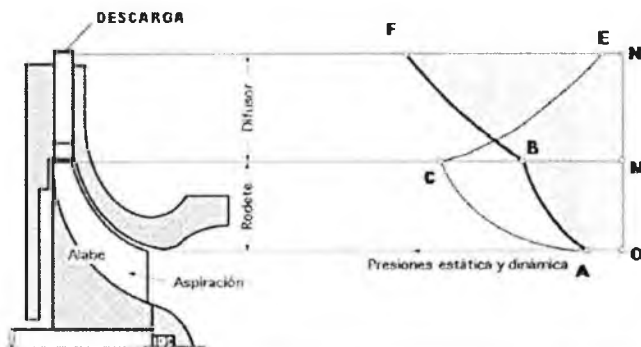
Figura 1. De O-A presión dinámica y estática. De M-B presión estática. De M-C presión dinámica. De N-E presión dinámica. De N-F presión estática
