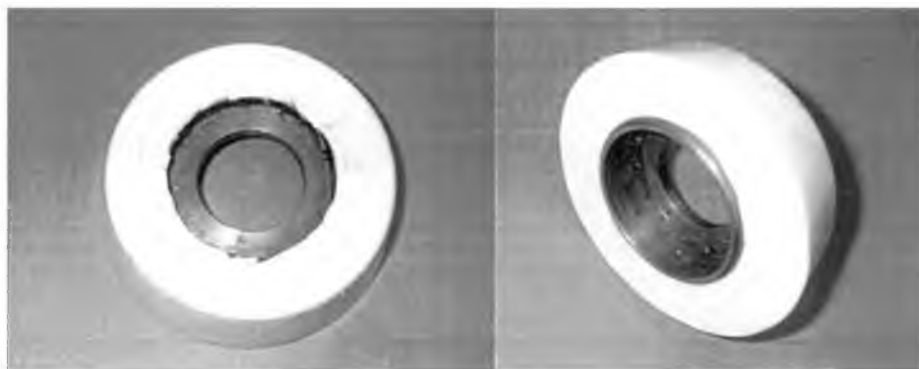
Figura 7. Elastómero de poliuretano vaciado en el estator de turbina para ser mecanizado.
