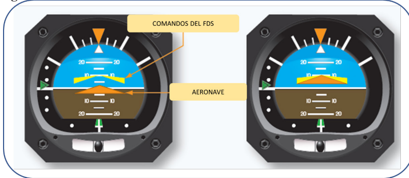
Figura 58. Comandos del director de vuelo - FDS en un indicador de actitud
