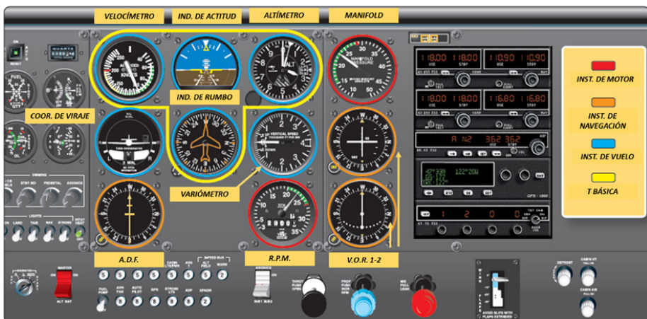
Figura 54. Disposición de los instrumentos en cabina
