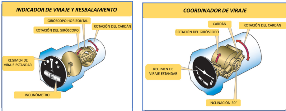
Figura 53. Indicador y Coordinador de viraje
