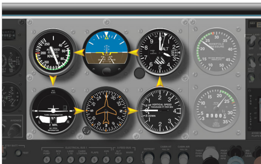
Figura 84. Chequeo cruzado - método rectangular
