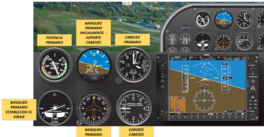
Figura 89. Indicaciones de los instrumentos en viraje
