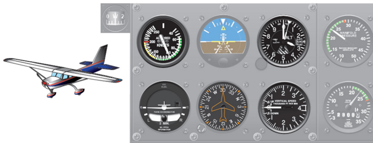
Figura 76. Instrumentos de comportamiento
