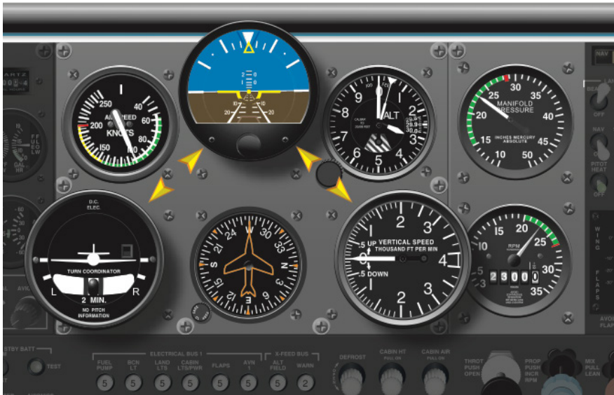
Figura 83. Chequeo cruzado - método V invertida
