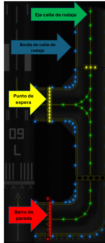
Figura 51. Luces de calle de rodaje
