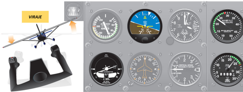
Figura 75. Instrumentos de control
