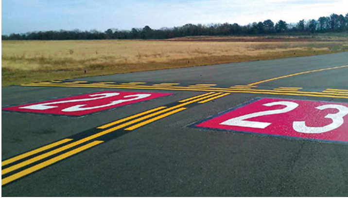
Figura 25. Señales de posición marcadas en la superficie en el punto de espera
