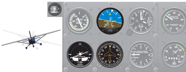
Figura 79. Instrumentos de indicación directa e indirecta de banqueo
