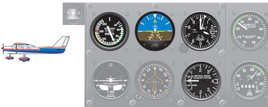
Figura 78. Instrumentos de indicación directa e indirecta de cabeceo
