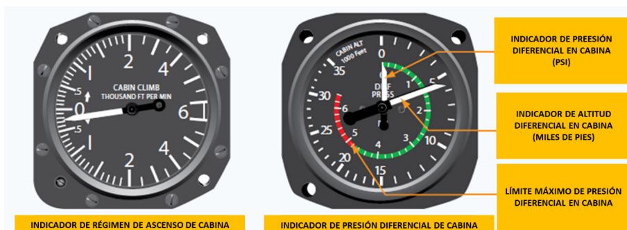
Figura 68. Indicadores del sistema de presurización
