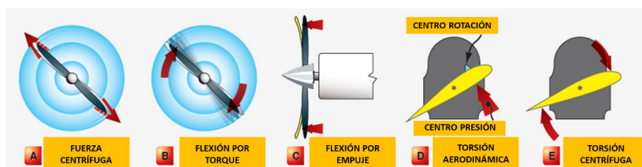
Figura 49. Fuerzas actuando sobre la hélice
