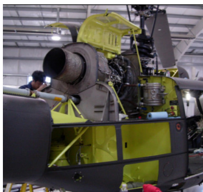
Figura 25. Tanque de un sistema de cárter seco
