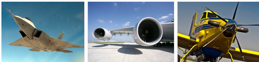
Figura 71. Entrada de aire motores de turbina
