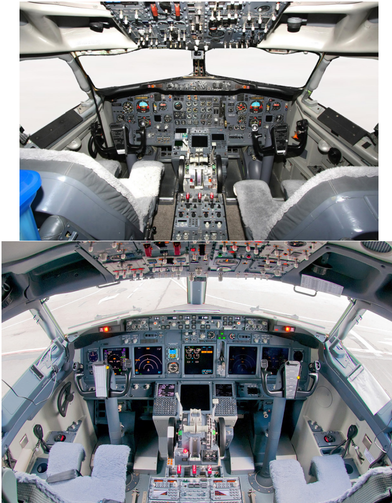
Figura 43. Cabina Boeing 737 análoga y digital
