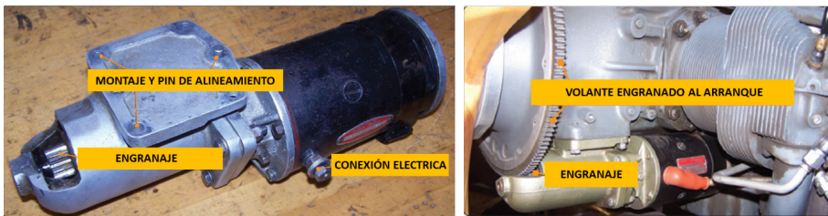
Figura 34. Conjunto de volante y arranque
