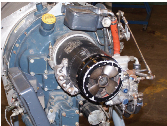
Figura 72. Sección de accesorios de un motor turbo hélice
