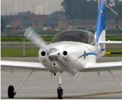
Figura 8. Toma de aire del sistema de inducción
