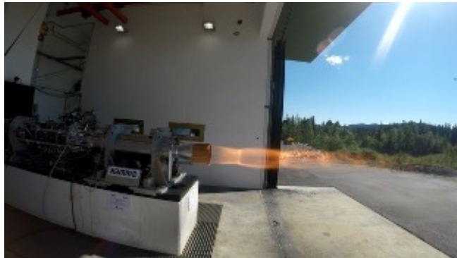
Figura 4. El motor híbrido de Nammo que impulso el cohete sonda Nucleus en una misión suborbital en Noruega [18].
