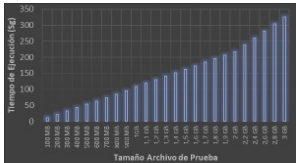
Figura 9. Comportamiento del algoritmo de cifrado AES durante fase de pruebas
