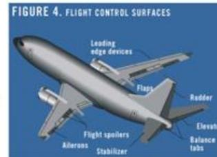
FIGURE 4. FLIGHT CONTROL SURFACES
