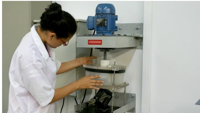
Figura 15. Tribómetro de eje vertical para estudio de fenómenos erosivos. Fuente: http://eime.univalle.edu.co/tribologia .
