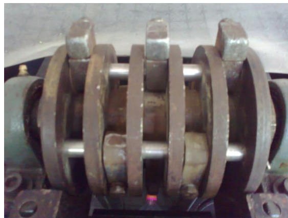
Figura 18. Tribómetro de martillos basculantes en laboratorio. Tiene capacidad para 10 martillos. Fuente: El autor.
