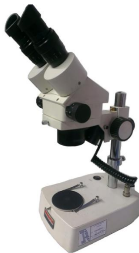
Figura 19. Stereo microscopio. Se utiliza para observar superficies magnificadas ciento 150 veces. Fuente: Grupo de Investigación en fatiga y superficies (GIFS) Universidad del Valle.
