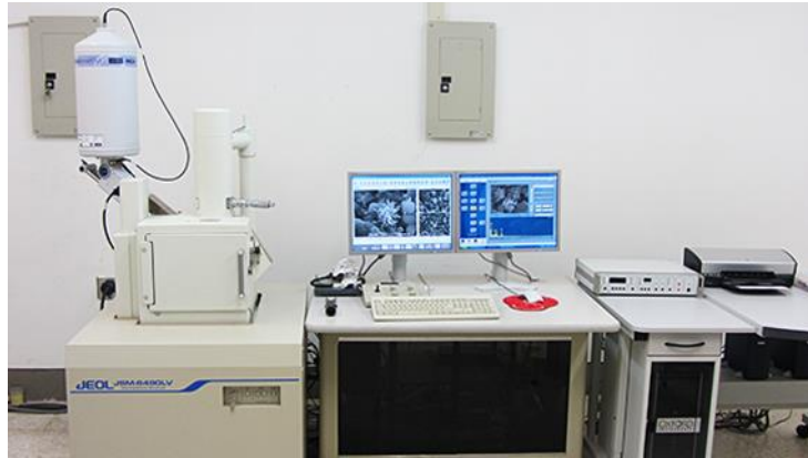
Figura 21. Microscopio electrónico de barrido. Capta imágenes de superficies magnificándolas 2000 veces o más. Fuente: http://eimat.univalle.edu.co/microscopia-electronica-de-barrido
