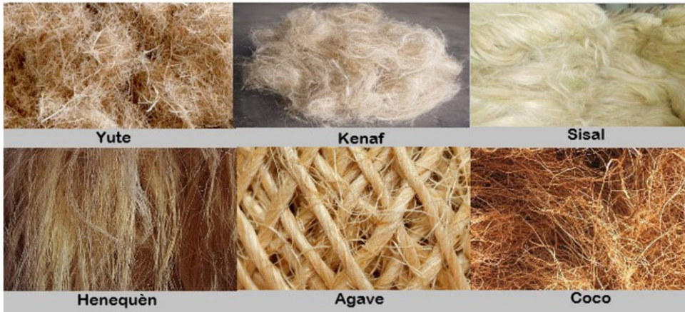
Figura 16. Algunos tipos de fibras naturales utilizadas en el reforzamiento de matrices poliméricas para la obtención de PMC. Fuente: [15].
