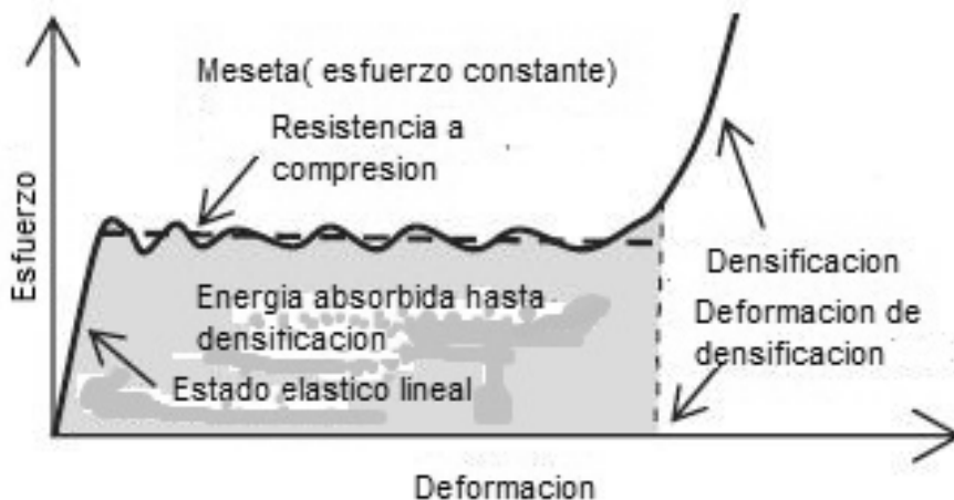
Figura 74. Curva esfuerzo-deformación obtenida para una espuma metálica de aluminio sometida a compresión. La carga se aplica lentamente. Fuente: adaptada de [20].
