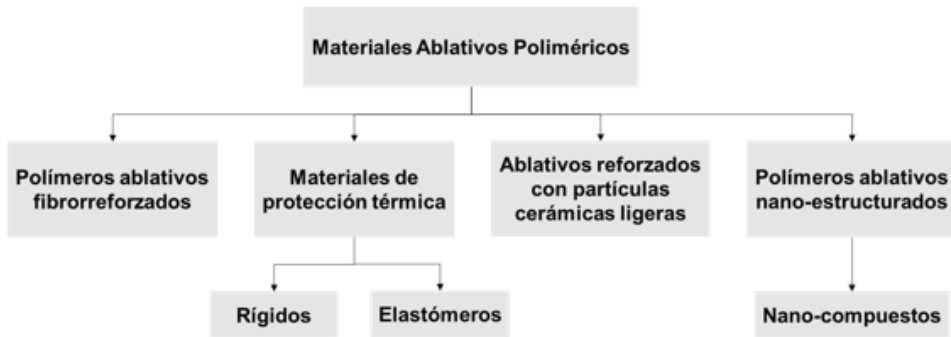
Figura 46. Clasificación de los materiales poliméricos ablativos. Fuente: adaptada de [5].
