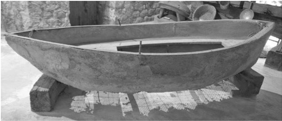
Figura 10. Primer bote del mundo en hormigón reforzado desarrollado por Jean Louis Lambot. Fuente: [60].
