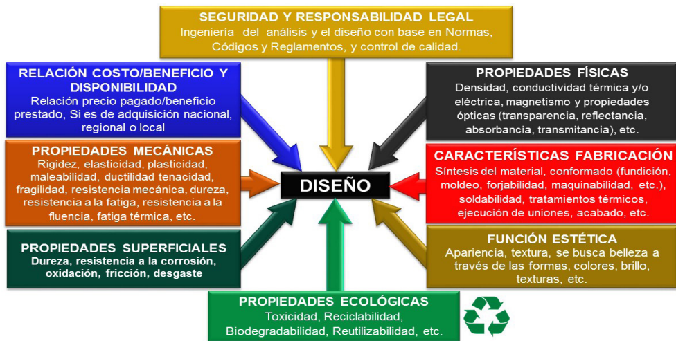
Figura 2. Factores y características que influyen en la selección y utilización de materiales utilizados en el diseño en ingeniería actual. Fuente: el autor.
