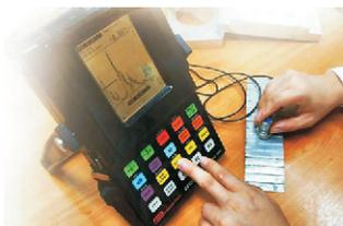
Figura 43. Equipo para la inspección por ultrasonido. Tomado de: <http://www.setsco.com/aerospace.aspx?pe8Kk/yk9C>
