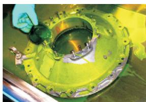
Figura 26. Aplicación de penetrante fluorescente en inspección por líquidos penetrantes. Visita LIAN/CAMAN/FAC.
