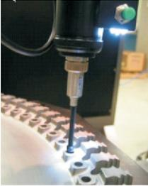
Figura 44. Sistema automatizado de inspección por corrientes inducidas en una rueda de turbina. Tomado de: <http://www.vamsterdam.nl/images/Eddy/EddyBolthole.jpg>
