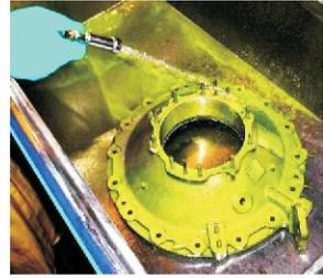
Figura 28. Remoción del exceso de penetrante método lavable con agua. Visita LIAN/CAMAN/FAC.
