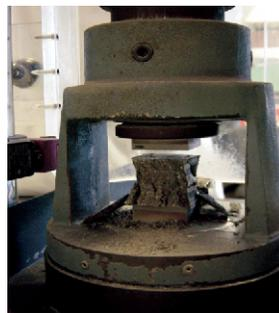
Figura 7. Elemento de Hormigón sometido al ensayo de compresión. Tomado de: [http://www.cuadernodelaboratorio.es/visita\\_cementera.htm](http://www.cuadernodelaboratorio.es/visita_cementera.htm)
