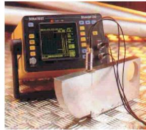
Figura 39. Calibración inicial de la señal buscada en el ensayo por ultrasonido. Tomado de: <http://www.kvinspection.com/Services/Ultrasoniinspection/>
