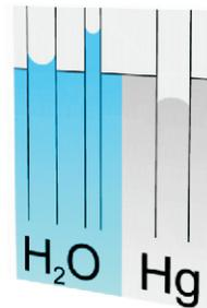
Figura 24. Efecto de la acción capilar sobre una columna de agua y sobre una de mercurio. Tomado de [http://es.wikibooks.org/wiki/F%C3%ADsica/Fer%C3%83menos\\_superficiales\\_de\\_lis\\_F%C3%ADquidos/Capilaridad](http://es.wikibooks.org/wiki/F%C3%ADsica/Fer%C3%83menos_superficiales_de_lis_F%C3%ADquidos/Capilaridad)
