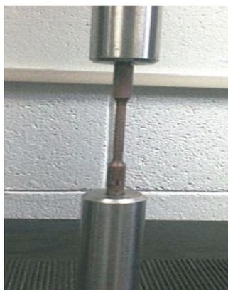
Figura 4. Montaje para el ensayo a tracción de una probeta de acero. Tomado de: <http://isarabaga.wordpress.com/ensayo-de-traccion/>
