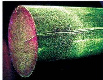
Figura 18. Barra de acero defectuosa detectada por END. Tomado de: <http://www.rsime.com/nondestructive.asp>
