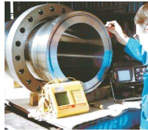
Figura 45. Inspección manual por corrientes inducidas. Tomado de: <http://www.veem.com/auimagesndt1.jpg>
