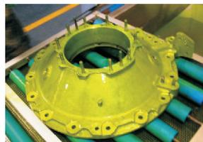
Figura 27. Componente en inspección en estación de penetración del líquido. Visita LIAN/CAMAN/FAC.
