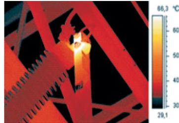
Figura 62. Termografía de instalación eléctrica de alta tensión con conexión mal fijada. Tomado de: <http://www.snewetsrisc.com/Aztectermografia.html>
