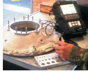
Figura 49. Calibración de la señal buscada en la pieza a inspeccionar mediante el bloque patrón. Visita LIAN/CAMAN/FAC.
