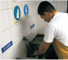
Figura 59. Proceso de revelado de las placas radiográficas expuestas. Visita LIAN/CAMAN/FAC.
