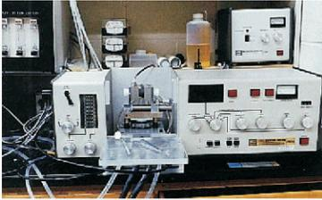
Figura 76. Espectrofotómetro de Absorción Atómica de horno de grafito.
