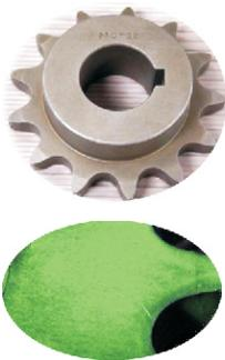
Figura 20. Pieza inspeccionada por END antes de ser puesta en servicio. Tomado de: <http://ceinsolac.com/servicios.html>
