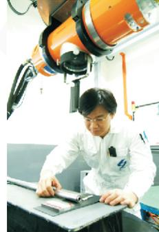
Figura 53. Inspección en banco fijo de radiografía industrial. Tomado de: <http://www.setsco.com/aerospace.asp?yK9CM>
