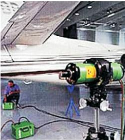
Figura 58: Exposición de las películas en el proceso de inspección por radiografía industrial. Tomado de: <http://www.ndt.org/EducatorResourcesCommunityCollegeRadiograph-1>
