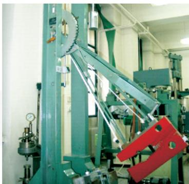
Figura 11. Péndulo Charpy para la realización del ensayo de resistencia al impacto. Tomado de: <http://www.eutii.upm.es/index/departamentos/mecanica/C%20instalaciones.htm>
