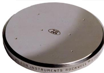
Figura 10. Patrón de calibración para el ensayo de dureza Rockwell. Tomado de: <http://www.qualites.net/html/dureza.htm>
