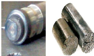
Figura 9. Falla característica de un material metálico sometido al ensayo de torsión. Tomado de: [http://www.foroswebgratis.com/tema-corte\\_de\\_eje\\_por\\_torsion-4119-582731.htm](http://www.foroswebgratis.com/tema-corte_de_eje_por_torsion-4119-582731.htm)
