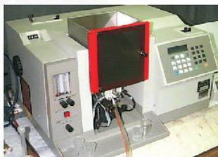
Figura 76. Espectrofotómetro de Absorción Atómica de llama. Tomado de: <http://elchem.kaist.ac.kr/vi/chem-ed/spec/atomic/graphics/aa.jpg>
