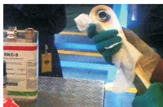
Figura 34. Pre limpieza componente aeronáutico para ser sometido a la inspección por partículas magnéticas. Visita LIAN/CAMAN/FAC.
