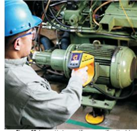
Figura 69. Inspección termográfica para verificación del funcionamiento en un motor eléctrico. Tomado de: <http://us.fliike.com/Images/Products/Industrial/Thermal>
