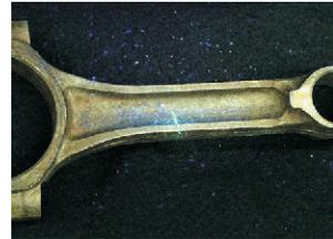
Figura 32. Biela de un motor aeronáutico inspeccionado por partículas magnéticas. Tomado de: <http://www.med-craft.com/working.html>
