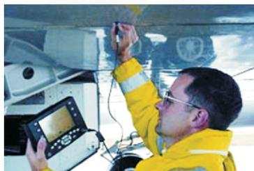
Figura 46. Inspección manual viga principal por corrientes inducidas. Tomado de: [http://www.amtonline.com/articlephotos1213710175963\\_sup\\_02.jpg](http://www.amtonline.com/articlephotos1213710175963_sup_02.jpg)
