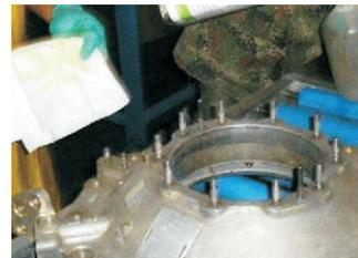
Figura 48. Pre limpieza componente aeronáutico para inspección por corrientes inducidas. Vista LIAN/CAMAN/FAC.
