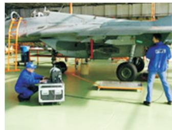
Figura 52. Inspección sobre los planos de un F-18 por radiografía industrial. Tomado de: [http://www.itwl.plenfoto1z\\_31.jpg](http://www.itwl.plenfoto1z_31.jpg)
