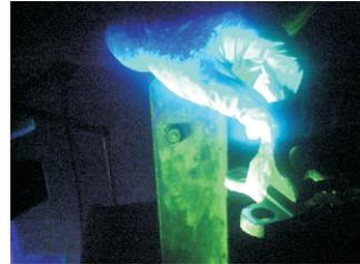
Figura 36. Inspección del componente magnetizado bajo luz negra. Visita LIAN/CAMAN/FAC.
