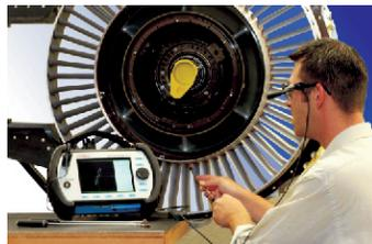
Figura 16. Componente aeronáutico en proceso de inspección por END superficial. Tomado de: [http://www.GE.com/GEIT-12002EN\\_aerospac](http://www.GE.com/GEIT-12002EN_aerospac)
