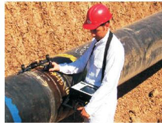
Figura 38. Inspección de soldaduras en un oleoducto por medio de ultrasonido. Tomado de: <http://www.advanced-ndt.co.uk/>
