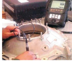
Figura 50. Barrido sobre la pieza inspeccionada por corrientes inducidas en busca de la señal previamente calibrada. Visita LIAN/CAMAN/FAC.
