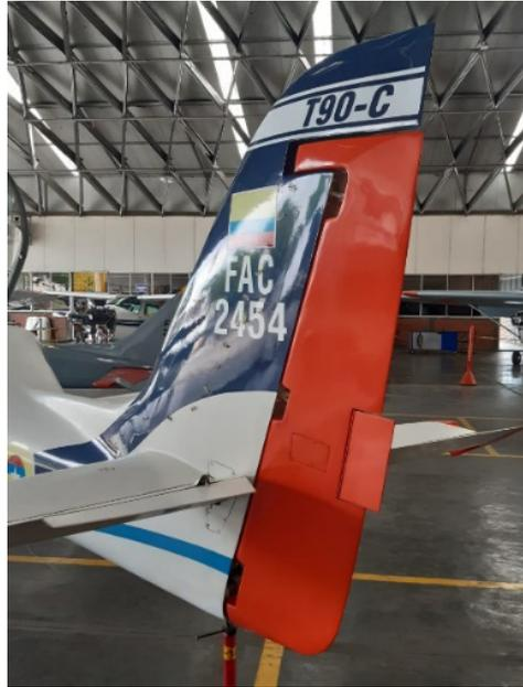
*Nota.* En la figura se observa el estabilizador vertical y horizontal del T-90 Calima. Fuente: Elaboración propia.
