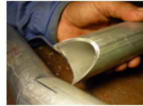
Figura 4. Unión de tubos en estructura del fuselaje. Fuente: El autor
