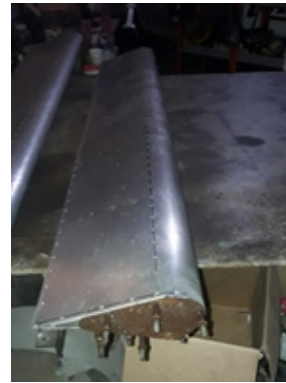
Figura 10. Los flaperones mejoran la sustentación en el despegue y el aterrizaje. Fuente: El autor.
