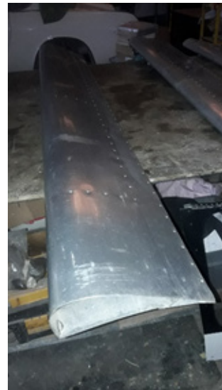
Figura 11. Slats borde de ataque. Fuente: El autor
