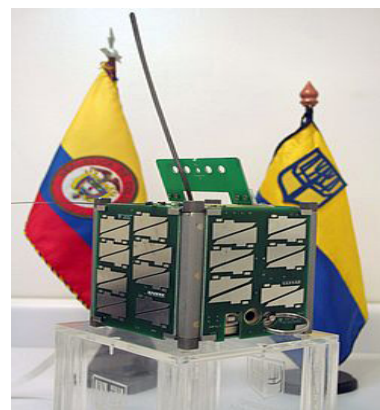
Figura 4. LIBERTAD 1: satélite artificial construido por el programa espacial de la Universidad Sergio Arboleda. Fuente: (Universidad Sergio Arboleda, 2007a).
