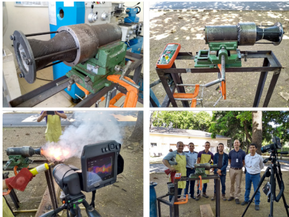
Figura 11. Pruebas de combustión estáticas de motores-cohetes de combustible sólido tipo Candy realizados por el Grupo de Investigación en Estudios Aeroespaciales de la Escuela Militar de Aviación "Marco Fidel Suárez". Fuente: Autores.
