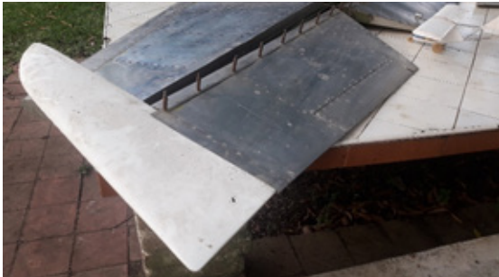
Figura 8. Timón de profundidad y estabilizador horizontal. Fuente: El autor.
