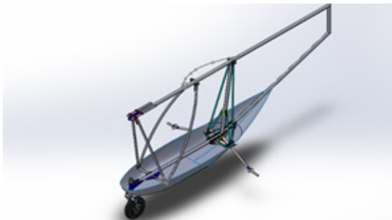
Figura 3. Estructura del fuselaje con barras de duraluminio y una base en forma de góndola fabricada en fibra de vidrio. Tren de aterrizaje tipo triciclo fijo. Fuente: El autor.
