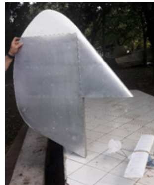
Figura 6. Estabilizador vertical del avión en construcción. Fuente: El Autor.
