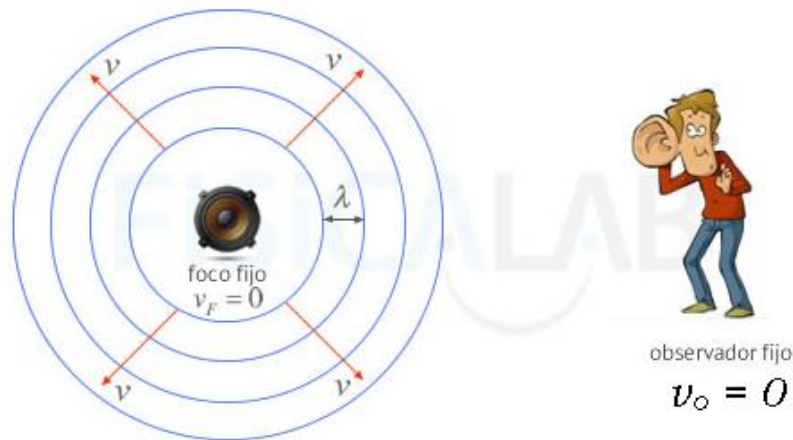
Figura 32. Foco y observador en reposo. Los círculos concéntricos de la figura representan los frentes de onda emitidos por el altavoz. A la derecha, un observador en reposo percibirá la misma longitud de onda \lambda emitida por el foco.
