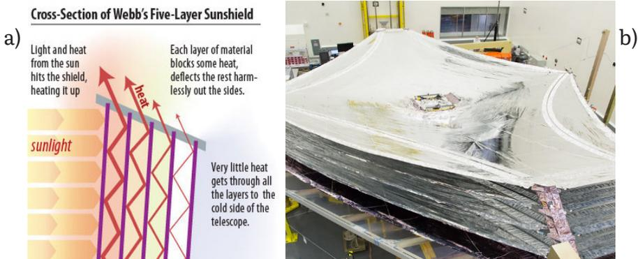
*Nota.* a) Ilustra cómo funciona el sistema de refrigeración de multicapas donde la radiación térmica después de varias reflexiones internas entre capas se dirige eficientemente hacia afuera produciendo un gradiente de temperatura considerable ( $\sim 350\text{K}$ ). Fuente. STScI.
